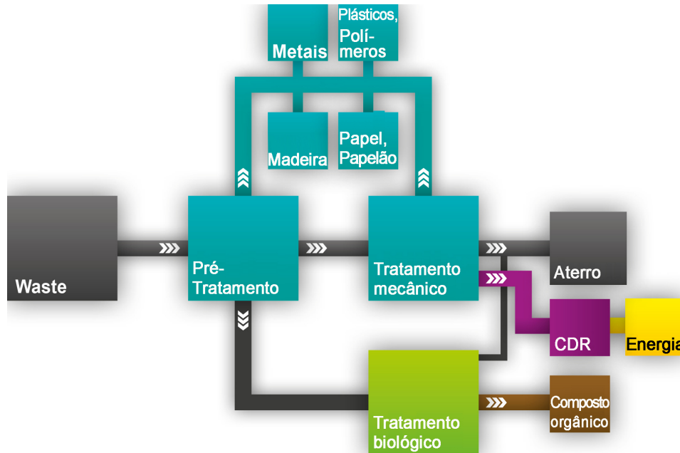
Figura 4-2 - Fluxograma do tratamento mecânico-biológico com compostagem
