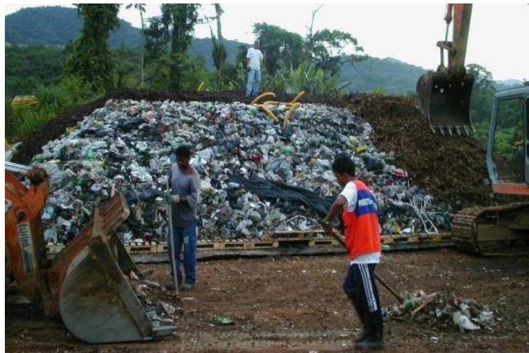
Figura 3-12 – Leira de compostagem com aeração passiva
