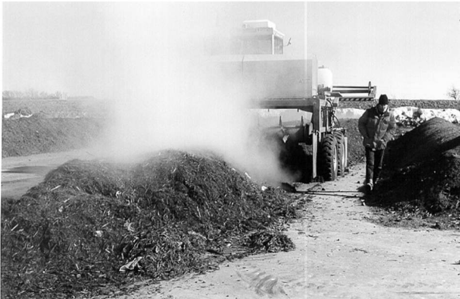
Figura 3-10 - Revolvimento de leira triangular
