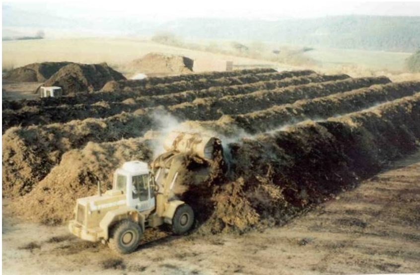
Figura 3-9 - Leira de compostagem, sendo montada e revirada por pá-carregadeira
