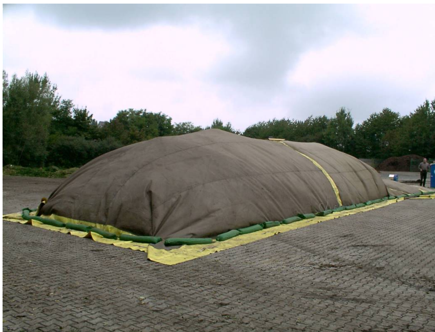
Figura 3-14 - Sistema em leiras envelopadas com aeração forçada
