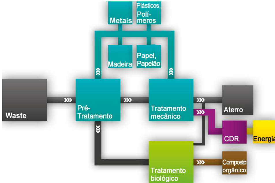
Figura 4-2 - Fluxograma do tratamento mecânico-biológico com compostagem
