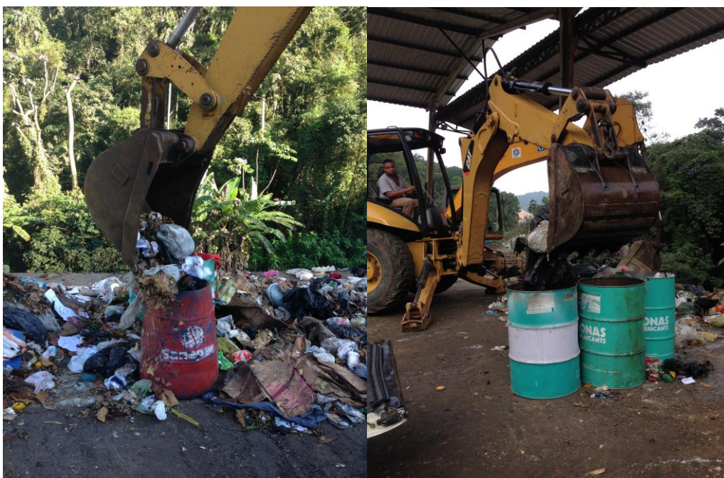
Figura 8-3 - Separação e alimentação de contêineres depois do quartejamento
